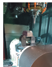
5軸制御マシニングセンタによる加工
