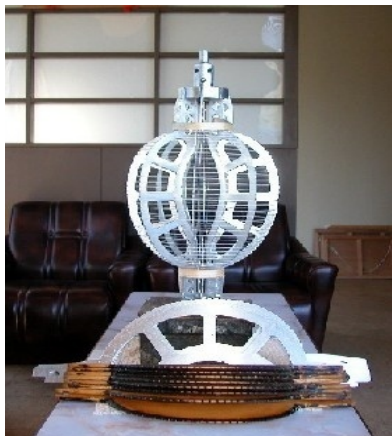
提灯のアルミ製型枠
