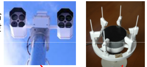
(路面状況センサー) (冬期気象センサー)
