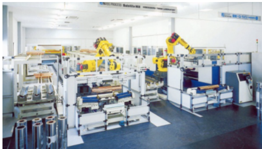
グラビア製版彫刻機械・完全無人化工場
