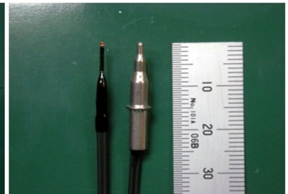
センサー部を水分から保護するため、樹脂コートにて絶縁処理を行い(左)、更にケーシングによってそのレベルを高めた温度センサー完成品(右)
