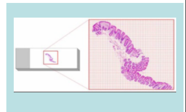
スライドガラス上の細胞をカメラで細かく分割して撮影するイメージ図
